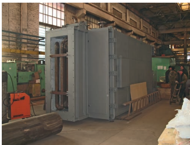
Печь для подогрева нефти змеевикового типа
