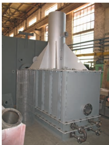
Печь для подогрева нефти змеевикового типа
