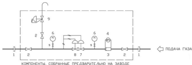
Сх.01 Группа редуцирования давления на одной линии
